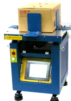
Fig1 輸送包装試験機 BF-50UT
