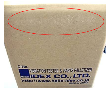
Fig.5 実輸送による擦れキズ
